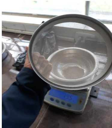
Desprender todas las partículas que quedan en la malla
