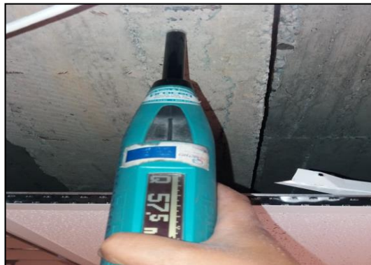
Figura 34: Ensayo del martillo esclerométrico
