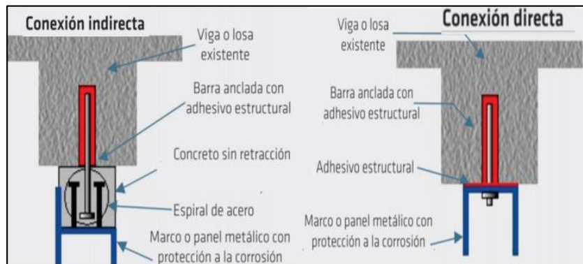
Figura 25: Detalle de las conexines de arriostamiento y paneles metálicos
