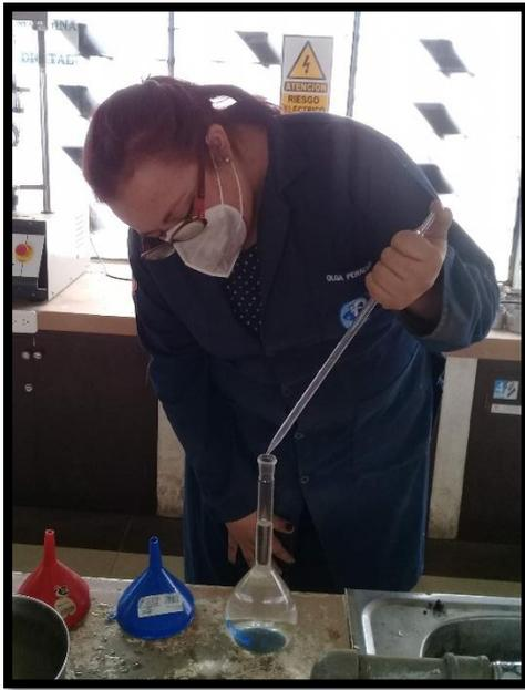
**Figura 26** Gravedad específica de los sólidos
