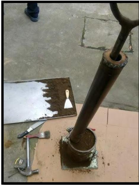
**Figura 30** Proctor Modificado tipo B
