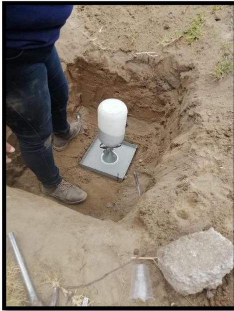
**Figura 24** Densidad de campo (Método del Cono y Arena de Ottawa)
