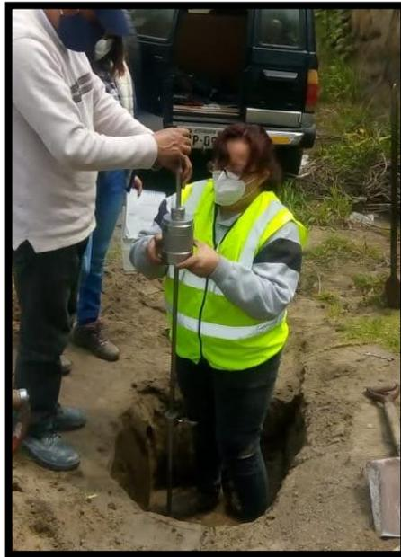
**Figura 25** Penetrómetro dinámico estático (DCP)
