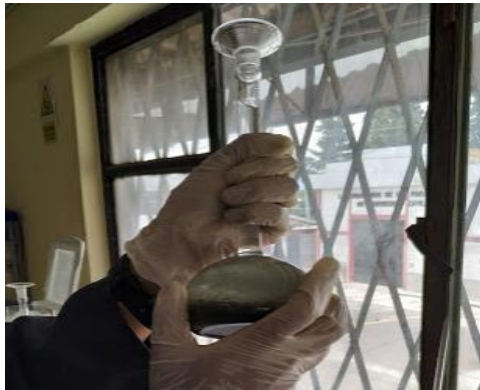
Figura 38. Determinación de la densidad real, Método de Le Chatelier.
