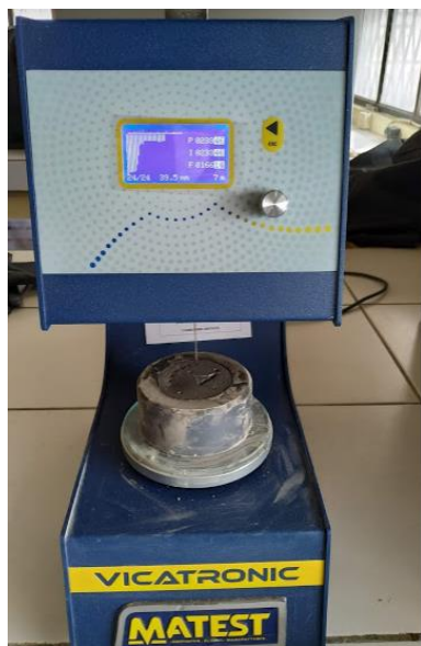
Figura 42. Determinación del tiempo de fraguado (Aparato de Vicat Automático).
