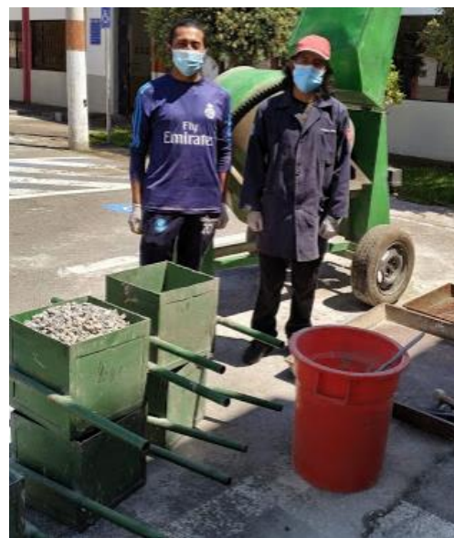
Figura 43. Elaboración de los especímenes de hormigón.
