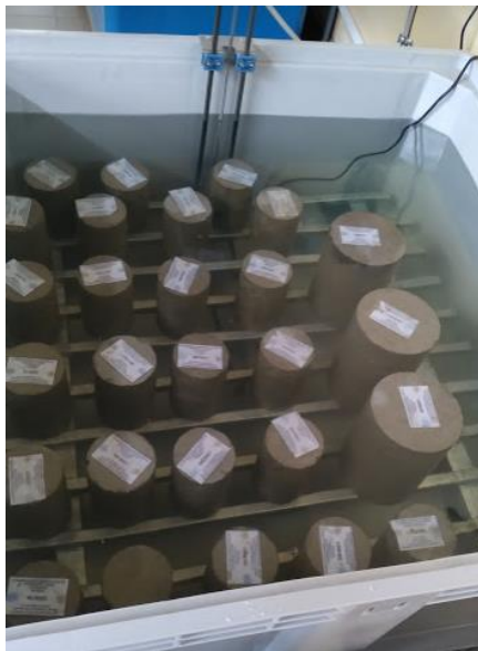
Figura 46. Curado del hormigón.
