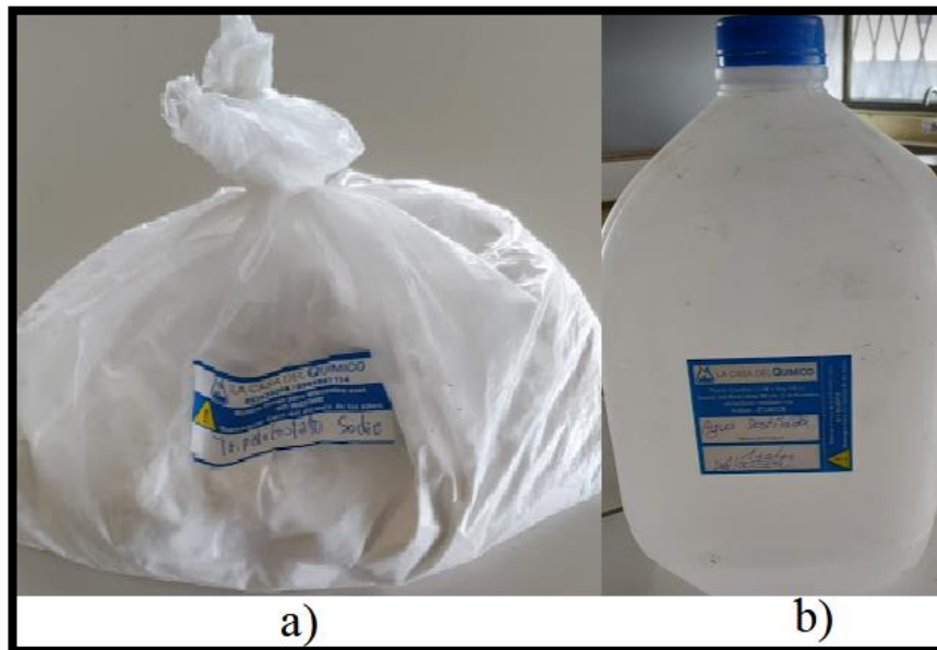
Figura 24. Solución defloculante. a) Tripolifosfato de sodio, b) Agua destilada.
