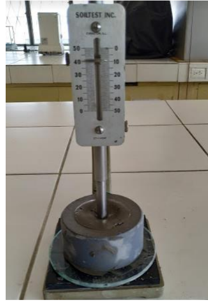
Figura 41. Determinación de la consistencia normal (Aparato de Vicat Manual).
