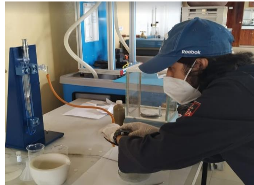
Figura 39. Determinación de la finura, Método del aparato de permeabilidad al aire Blaine.
