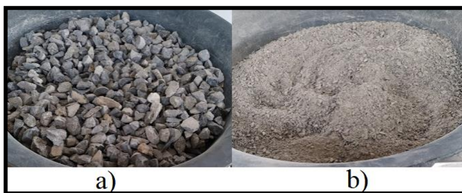
Figura 5. Agregados o áridos. a) Agregado Grueso, b) Agregado Fino.
