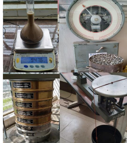
Figura 37. Ensayos de los agregados para la dosificación del hormigón.
