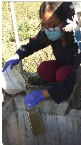
Figura 13. Muestreo del agua residual al ingreso de la PTAR
