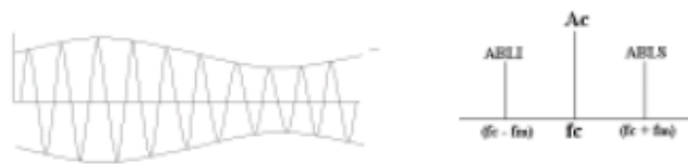
Fig. 067 Señal modulada en amplitud, espectro de la señal modulada en amplitud
