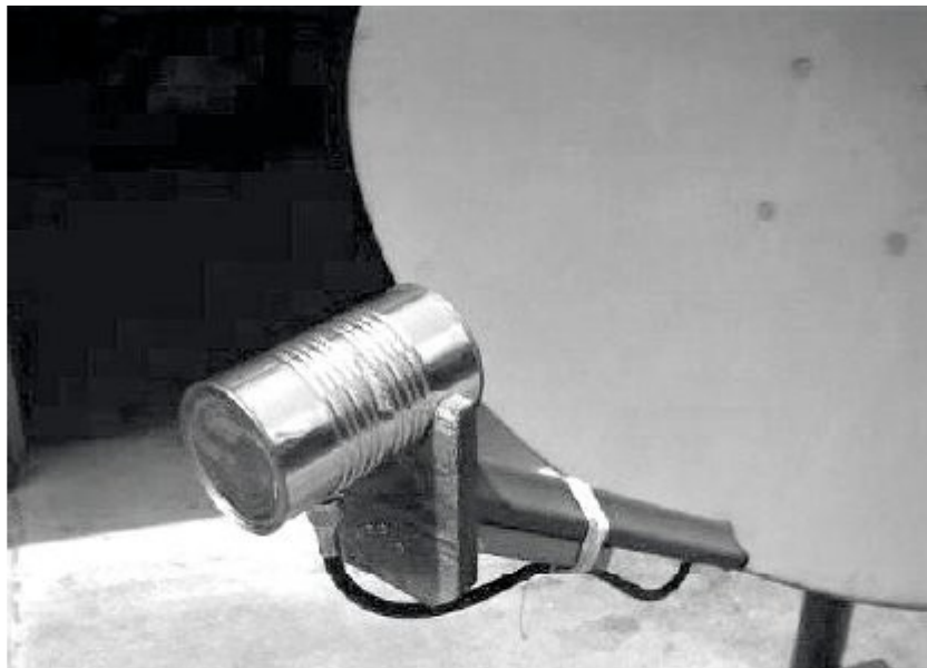
Fig. 017 Antena bocina hecha con una lata de comida
