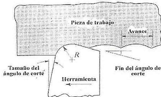
Fig. 12 Marcas que se generan por la herramienta de corte [18]
