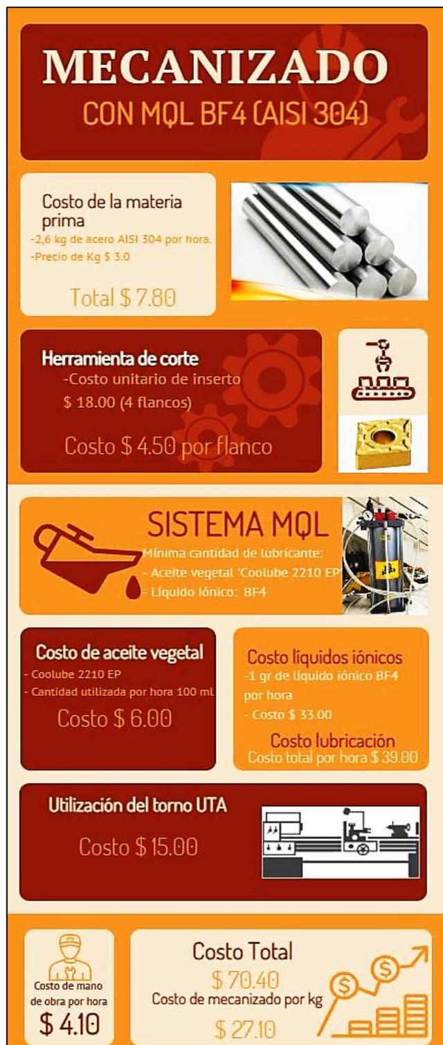
Fig. 70 Costo de mecanizado para el acero AISI 304 con lubricación MQL + 1%BF<sub>4</sub>
