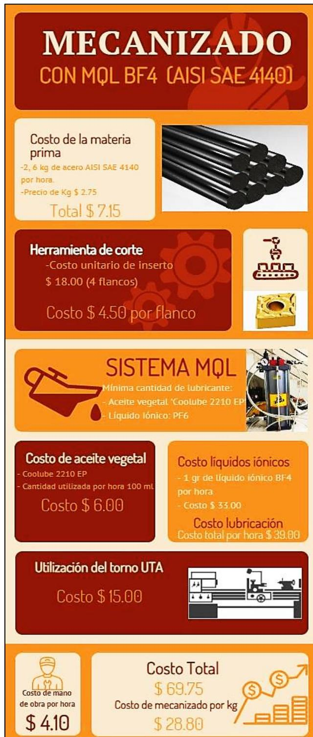
Fig. 72 Costo de mecanizado para el acero AISI/SAE 4140 con lubricación MQL + 1%BF<sub>4</sub>
