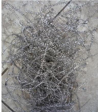
*Fig. 66 Tipo de viruta de mecanizado con sistema MQL+ Líquidos iónicos en el acero AISI SAE 4140*
