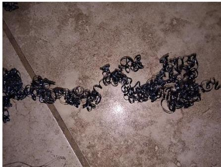
*Fig. 65 Tipo de viruta de mecanizado en seco en el acero AISI SAE 4140*
