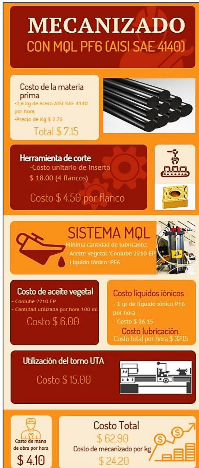
Fig. 71 Costo de mecanizado para el acero AISI/SAE 4140 con lubricación MQL + 1%PF<sub>6</sub>
