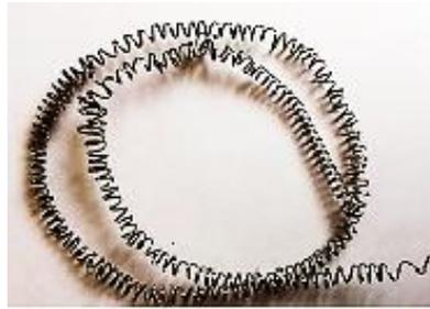
*Fig. 63 Tipo de viruta de mecanizado en seco en el acero AISI 304 [21]*
