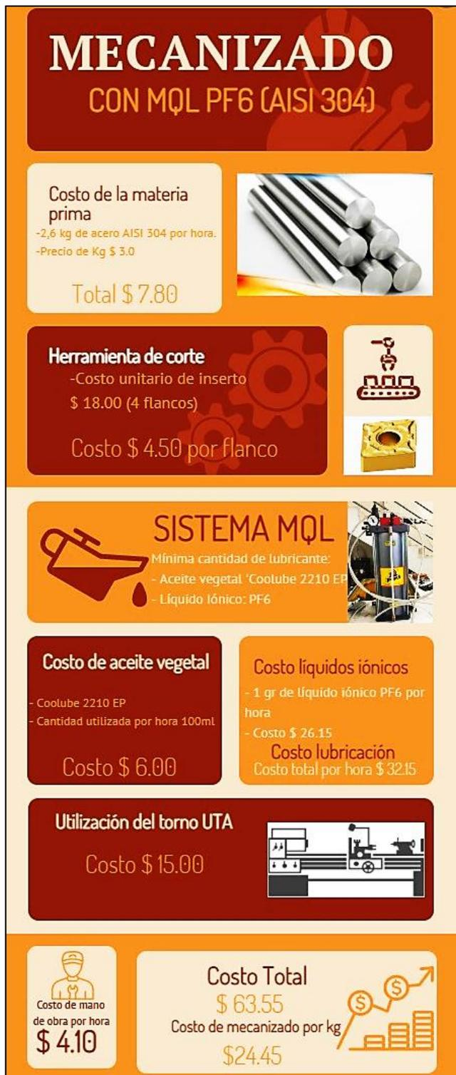
Fig. 69 Costo de mecanizado para el acero AISI 304 con lubricación MQL + 1%PF<sub>6</sub>
