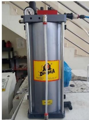
*Fig. 40 Sistema de mínima cantidad de lubricación MQL*
