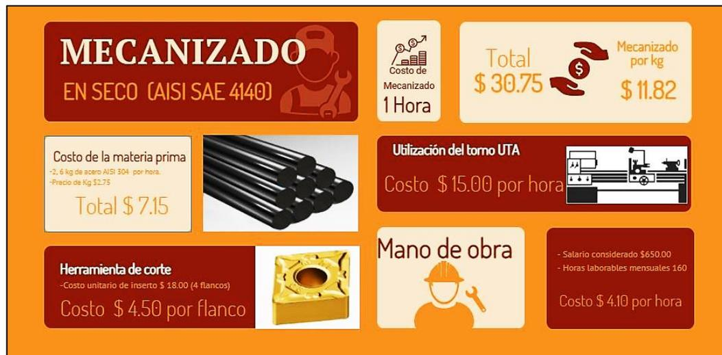
Fig. 68 Costo del mecanizado en seco para AISI/SAE 4140
