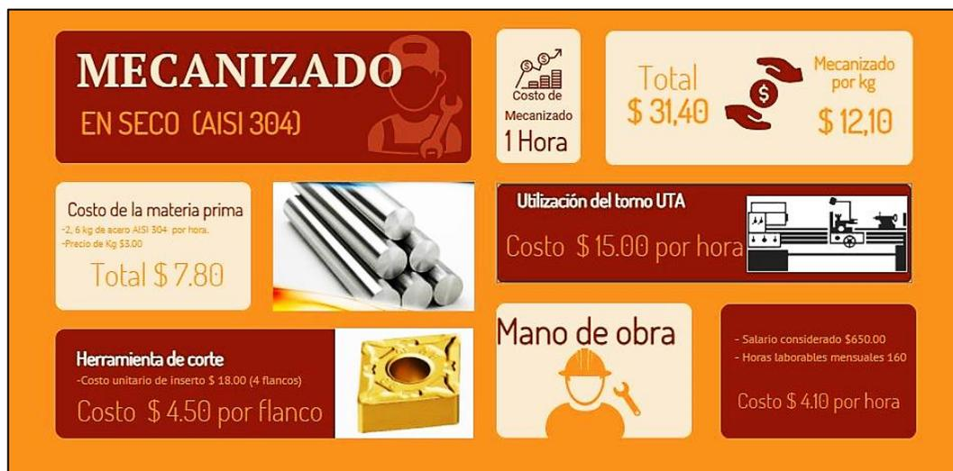
Fig. 67 Costo del mecanizado en seco para AISI 304
