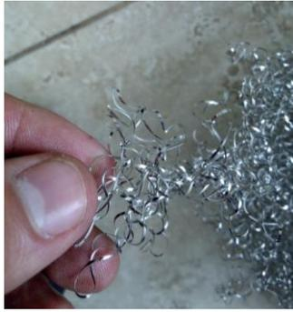
*Fig. 64 Tipo de viruta de mecanizado con sistema MQL+ Líquidos iónicos en el acero AISI 304*
