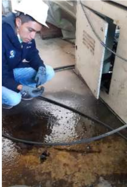
Figura 3.11.- Inyectora de Polímero IIP-002 (Evidencia de fijas de aceite). Autor
