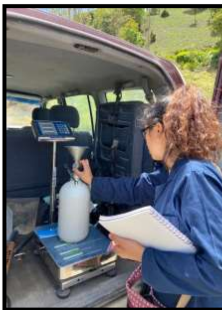
Determinación diferencia de peso inicial y peso final del cono de arena de Ottawa
