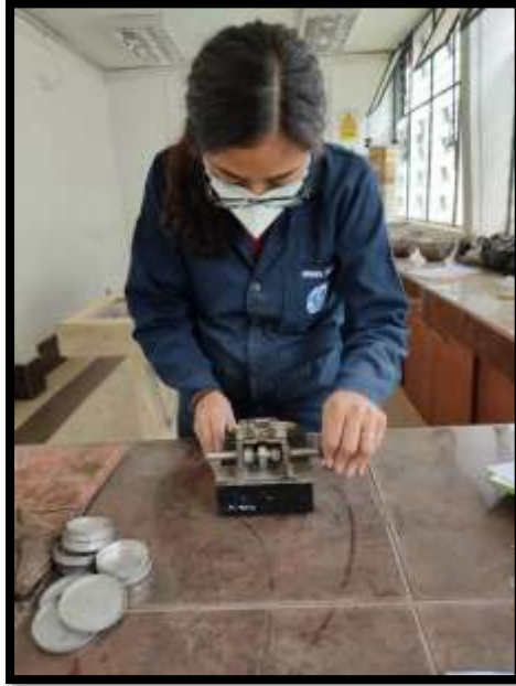
Ensayo Copa Casa Grande
