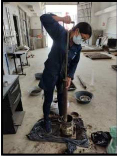
Compactación de suelo
