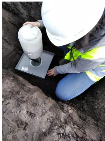
Figura 21. Ensayo cono y arena de Ottawa
