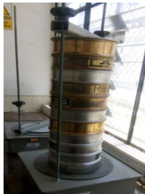
Figura 24. Colocación de tamices en la tamizadora
