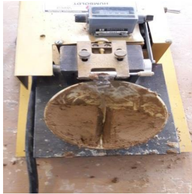
Figura 25. Muestra de suelo en la copa Casagrande
