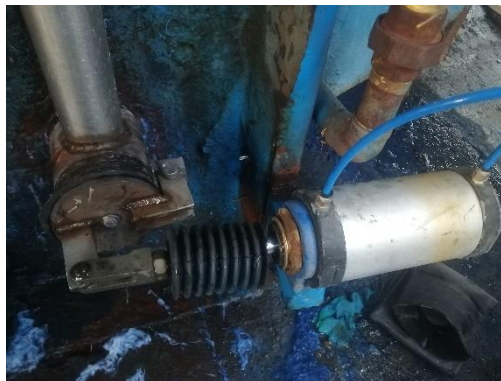
Figura. 17: Actuador y mecanismo de descarga [Autor]
