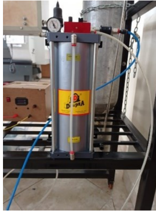
Figura 17. Sistema de mínima cantidad de lubricante para herramientas de mecanizado.
