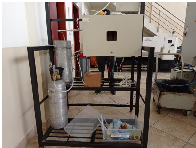
Figura 23. Sistema criogénico de distribución y dosificación de CO 2 . Fuente: Autor
