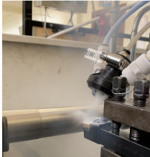
Figura 34. Enfriamiento de la herramienta de corte mediante fluido criogénico (CO 2 ) y aceite vegetal + Nano TiO 2 . Fuente: Autor.
