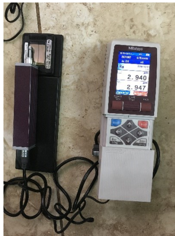
Figura 22. Rugosímetro Mitutoyo SJ-210 y su calibración con un patrón estándar.
