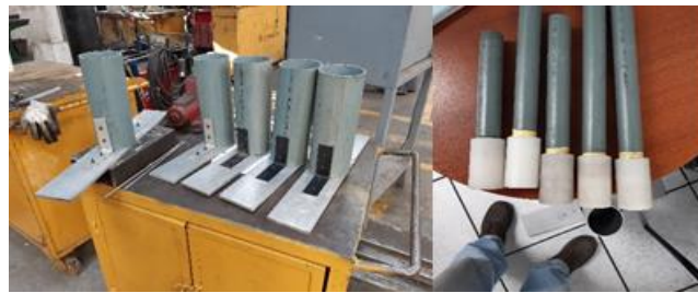
Figura 40: Bases para los transmisores de nivel.
