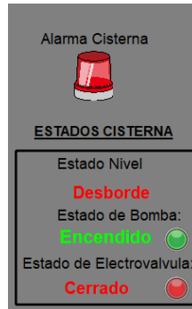
Figura 62: Estado de Cisterna.
