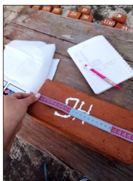
Ilustración 64. Toma de las medidas correspondientes de las probetas.
