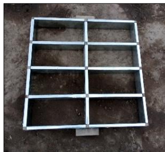
Ilustración 29. Molde para los ladrillos
