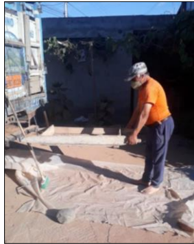
Ilustración 23. Tamizado de los suelos arcillosos triturados
