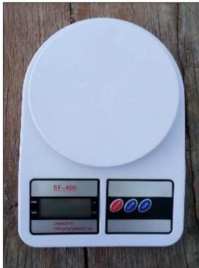
Ilustración 46. Balanza Electronica, capacidad máx. 7000 g.
