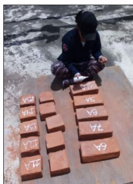
Ilustración 63. Codificación de las probetas.
