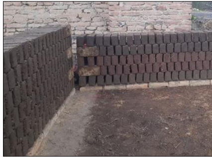
Ilustración 36. Apilamiento de los ladrillos
