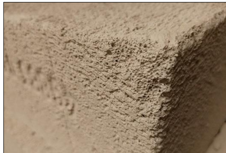
Ilustración 8. Porosidad del ladrillo después de la cocción.
