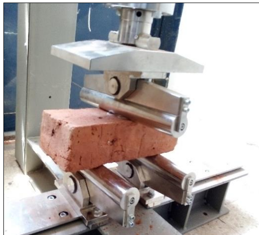
Ilustración 44. Ejecución del Ensayo a la Resistencia a la Flexión
