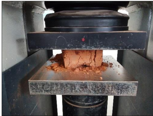
Ilustración 42. Ejecución del ensayo de la resistencia de la compresión de las probetas
