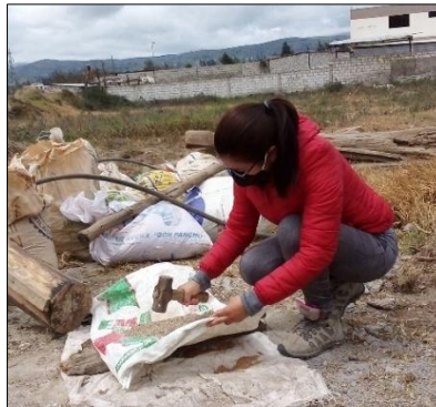
Ilustración 22. Trituración de los suelos arcillosos
