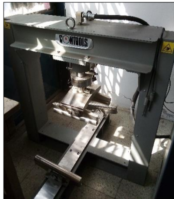
Ilustración 69. Máquina de Flexión "Controls"
