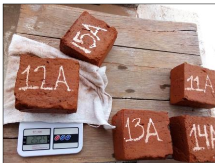
Ilustración 65. Toma del peso de las probetas.
