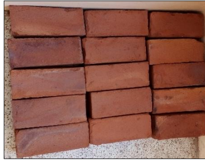
Ilustración 9. Coloración después de la cocción de la arcilla
