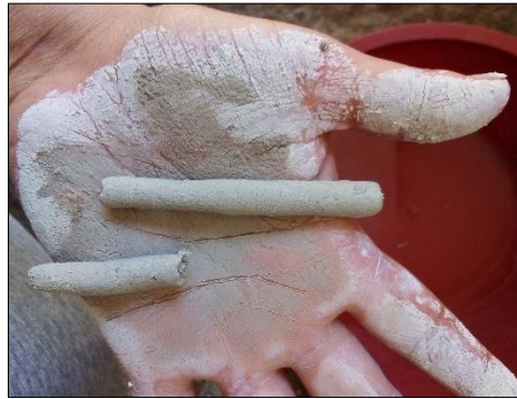
Ilustración 5. Arcilla con agua y moldeada
