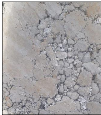
Ilustración 21. Suelo arcilloso tendido
