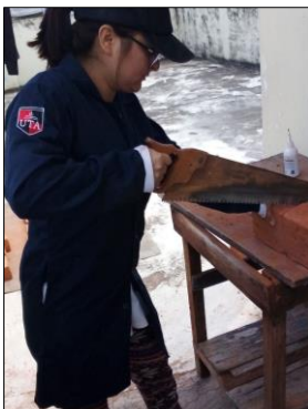
Ilustración 62. Preparación de las probetas para los ensayos de Compresión y Absorción de Humedad.
