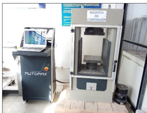
Ilustración 67. Máquina de Compresión “Controls” modelo: C78Z00,
