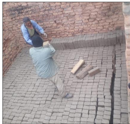
Ilustración 39. Ubicación de los ladrillos dentro del horno
