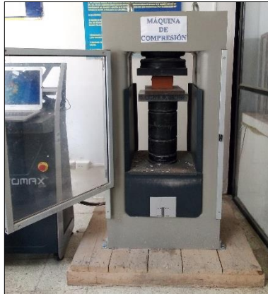
Ilustración 68. Colocación de las probetas en la Máquina de Compresión
