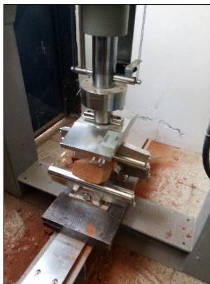
Ilustración 70. Ensayo de la determinación a la Flexión de una de las probetas.
