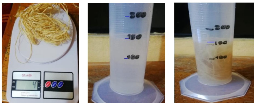
Figura 20. Materiales y procedimiento para el cálculo de la densidad de la fibra
