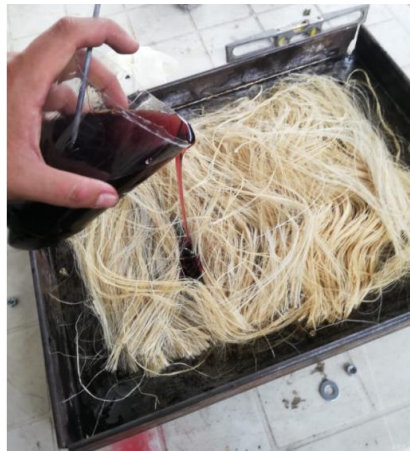
Figura 32. Relleno de molde con resina poliéster.
