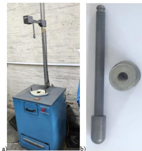
Figura 39. a) Máquina de ensayos de Impacto, b) Dardo con masas de arandelas.
