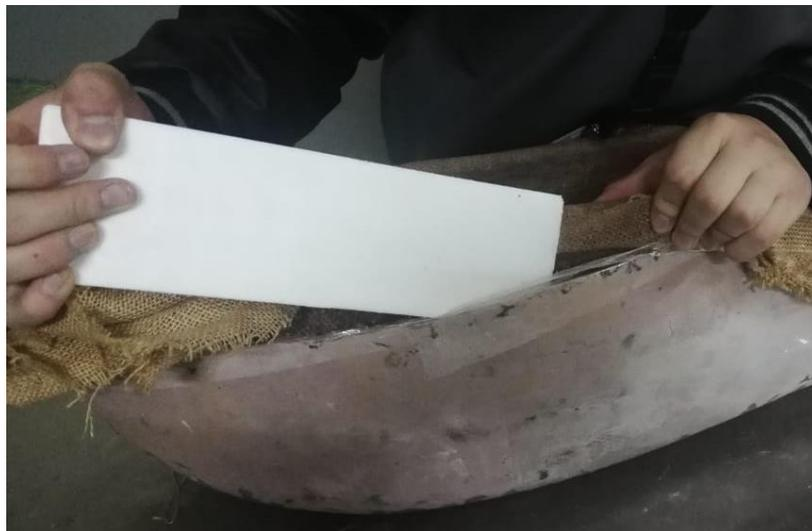
**Figura 58:** Desmolde del carenado del vehículo
