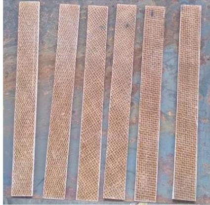
**Figura 10:** Probetas para ensayo de tracción del biocompuesto
