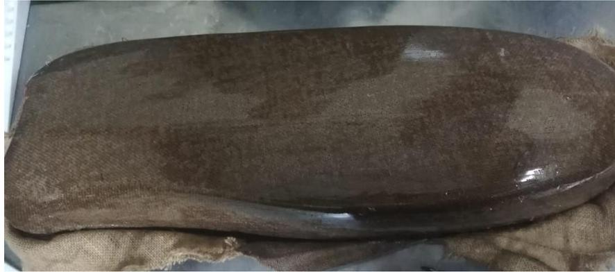
**Figura 59:** Estructura carenado terminado
