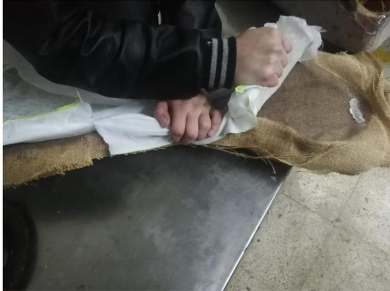
**Figura 57:** Retiro del papel desmoldante
