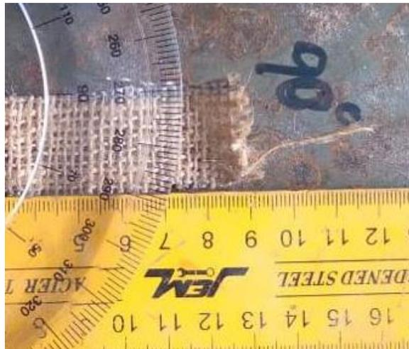
**Figura 8:** Corte de fibra de yute a  $90^\circ$
