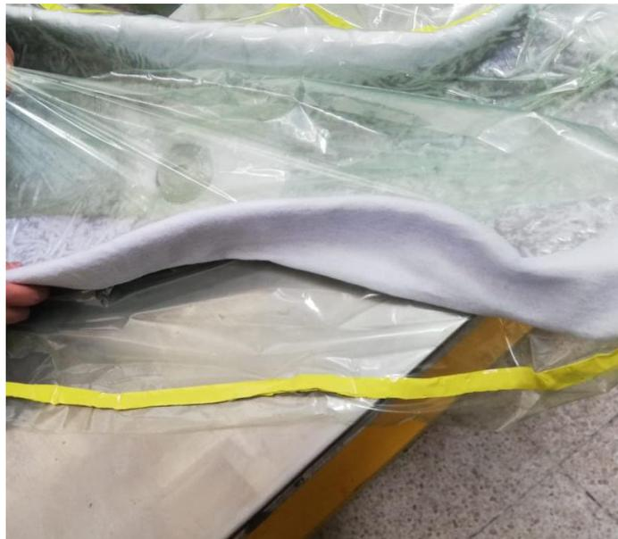
**Figura 56:** Retiro del plástico de vacío
