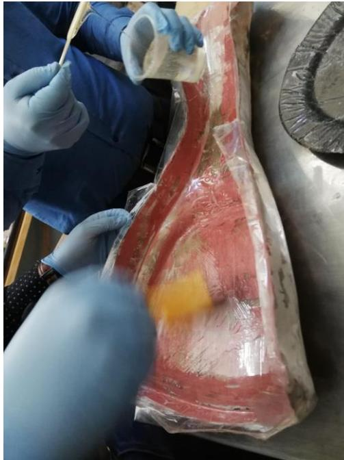
**Figura 52:** Aplicación de cera desmoldante
