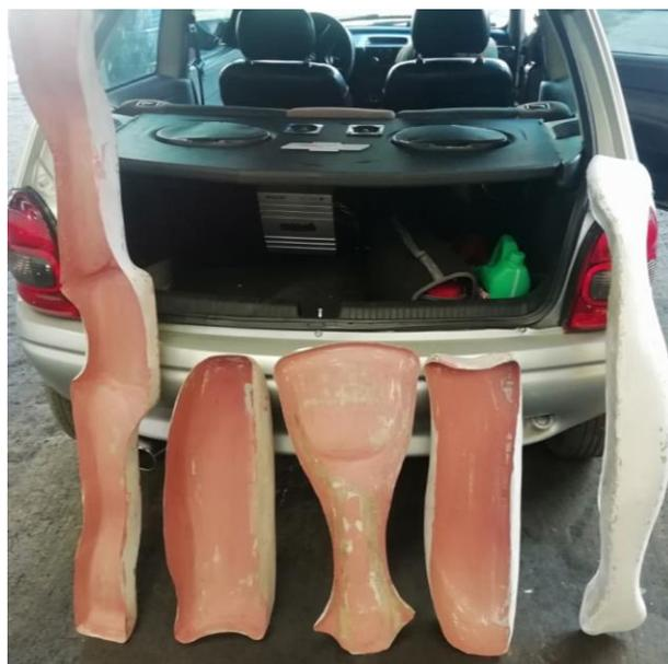
**Figura 49:** Molde de la carrocería del go kart
