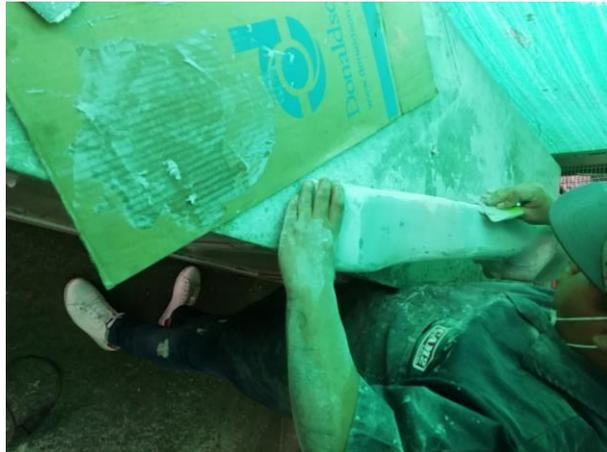
**Figura 48:** Proceso del moldeo del carenado lateral
