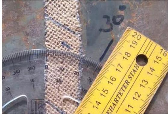
**Figura 7:** Corte de fibra de yute a  $60^\circ$  de inclinación
