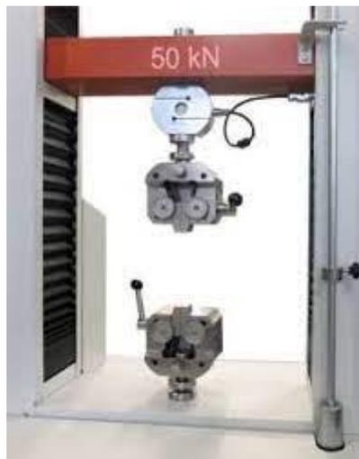
**Figura 11:** Máquina de ensayos de tracción universal Metrotest 50KN
