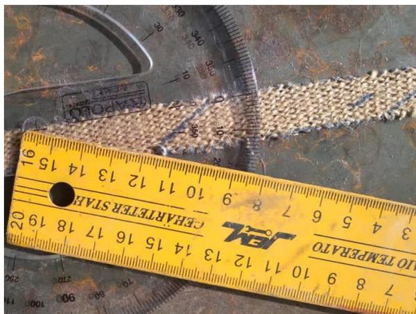
**Figura 6:** Corte de la fibra de yute a 45° de inclinación
