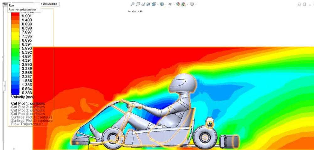
**Figura 44:** velocidad del fluido lateral máxima 12,07 m/s
