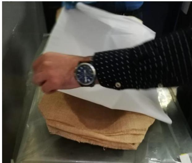
**Figura 54:** Aplicación papel desmoldante
