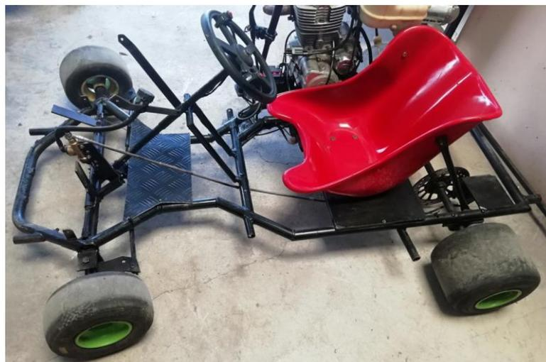
**Figura 60:** Go kart para colocar la carrocería
