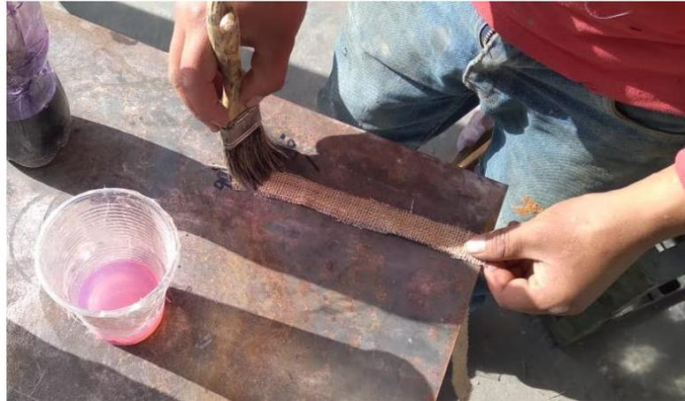
**Figura 9:** Proceso obtención de probeta de resina epoxi con la fibra del yute
