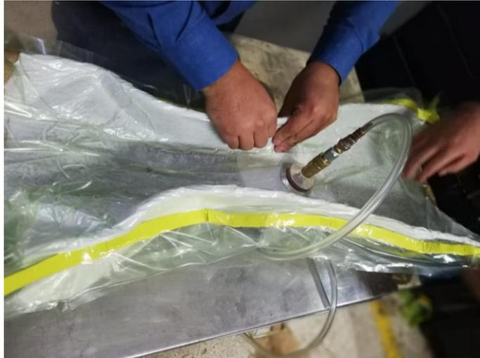
**Figura 55:** Técnica de moldeo al vacío
