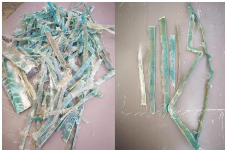
Figura 18: Residuos de material compuesto con matriz de resina poliéster reforzado con fibra de vidrio
