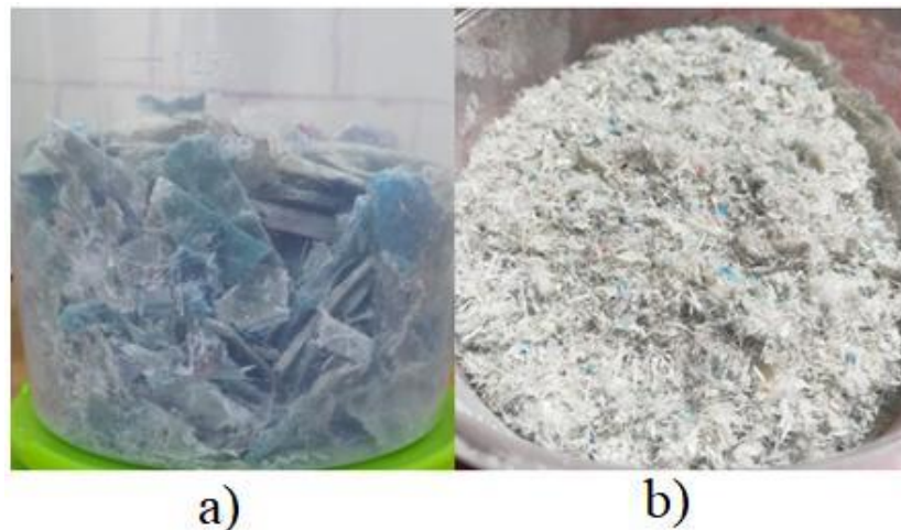
Figura 29: a) Residuo de GFRP, b) Triturado de GFRP
