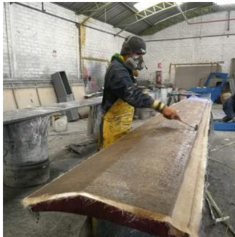
Figura 8: Proceso de fibrado canastilla de bus
