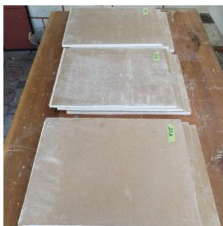
Figura 38: Probetas para ensayo a flexión con diferentes espesores
