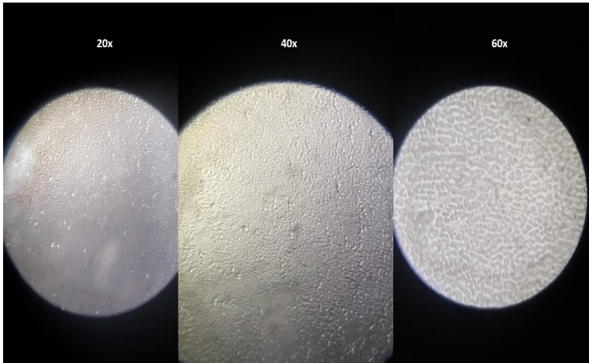
Figura 20. Microscopia óptica del nitrato de celulosa con muestra de 106 \mu\text{m}
