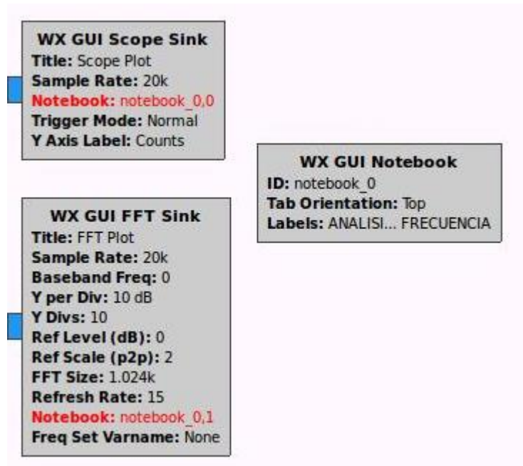
Figura 20. Bloques WX GUI para análisis en frecuencia y tiempo.
