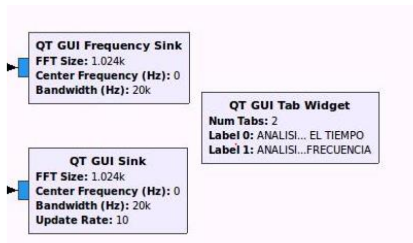
Figura 19. Bloques QT GUI para análisis en frecuencia y tiempo.
