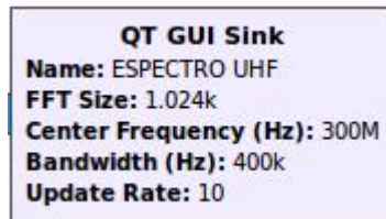
Figura 23. Bloque para la visualización de resultados del analizador UHF.
