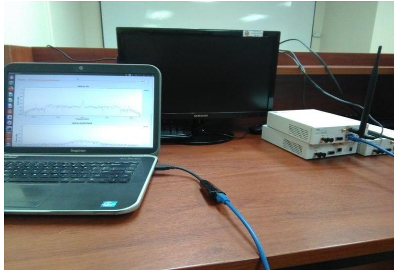
Figura 42. Conexión entre GNU Radio y USRP N210.
