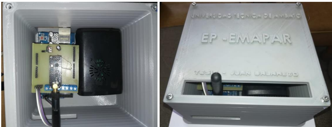
Figura 3.28: Ubicación de los servidores inalámbrico y LAMP
