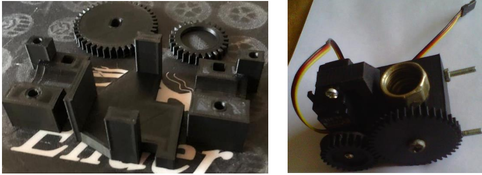
Figura 3.30: Creación de la Servo Válvula con impresión 3D
