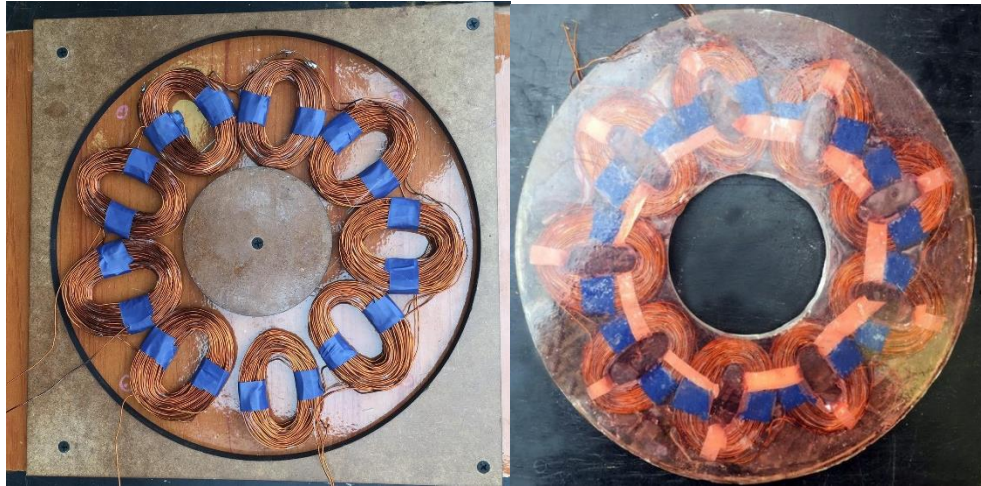
Figura 63: (a) Molde construcción estator (b) estator finalizado
