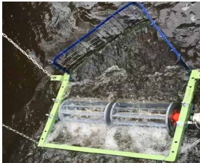
Figura 15: Turbina Michell-Banki en el canal de riego Ambato-Huachi-Pelileo. [32]
