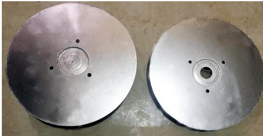
Figura 56: Platos de acero con las perforaciones.
