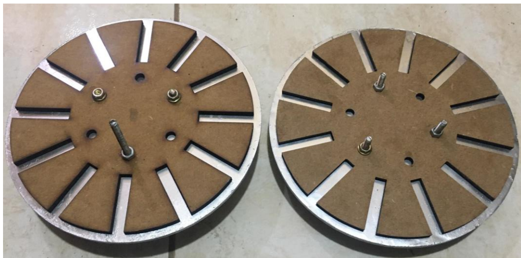
Figura 58: Rotores preparados para la fijación de los imanes permanentes.
