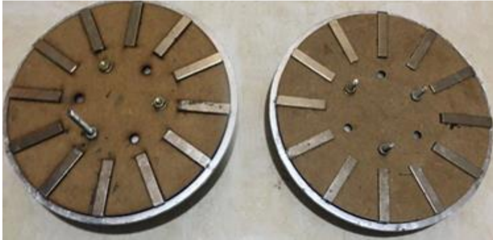
Figura 59: Rotores con los imanes pegados Elaborado por el autor.
