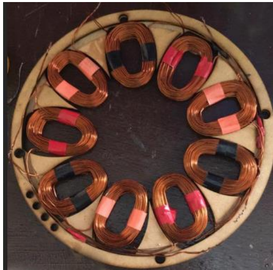
Figura 62: Ubicación de bobinas para construcción del estator.
