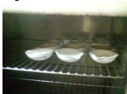
Figura #10: Medición de Humedad
