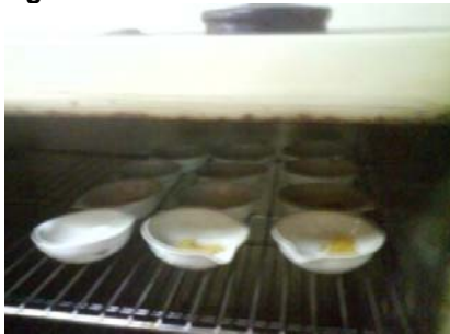
Figura #9: Medición de Humedad
