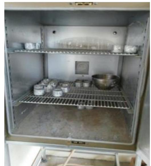
Secado en el horno de muestras de suelo previamente ensayadas
