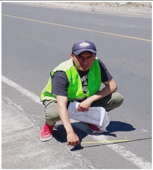
Medición desde el borde de la vía para iniciar el ensayo con la viga Benkelman
