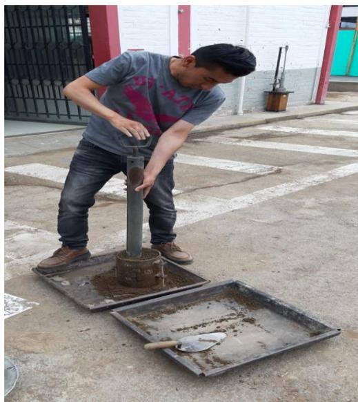
Ejecución del ensayo de compactación (Proctor Modificado)
