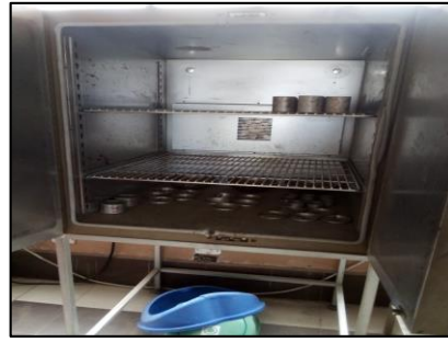
Fotografía N°20 Secado de muestras en horno.
