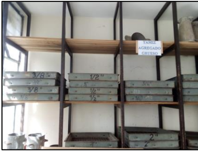
Fotografía N°13 Materiales para ensayo de granulometría
