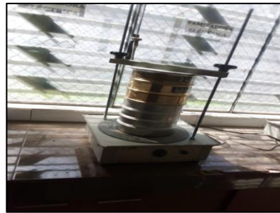
Fotografía N°18 ensayo de granulometría
