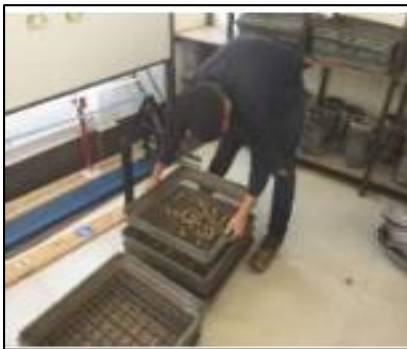
Fotografía N°15 ensayo de granulometría
