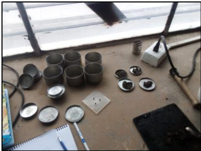
Fotografía N°11 Materiales para ensayo de límites de Atterberg.
