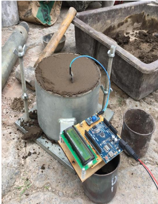
Fig. 29 Contenido de humedad (Proctor modificado Tipo B – Sensor resistivo).
