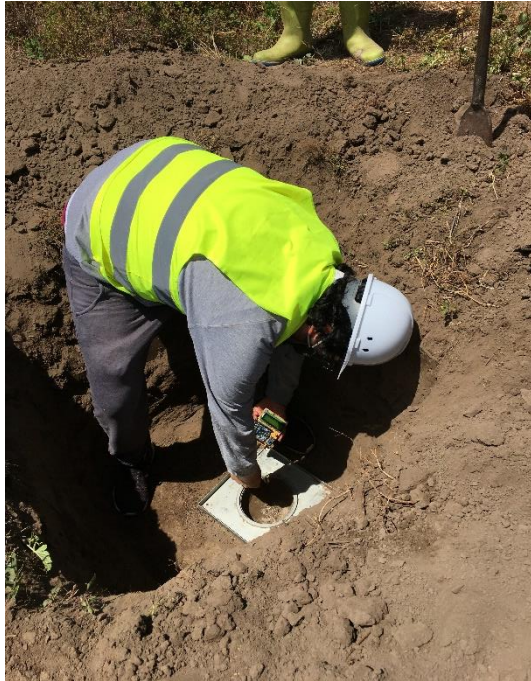
Fig. 25 Contenido de humedad (Muestras de Densidad de Campo – Sensor resistivo).
