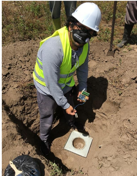
Fig. 24 Contenido de humedad (Muestras de Densidad de Campo – Sensor resistivo).
