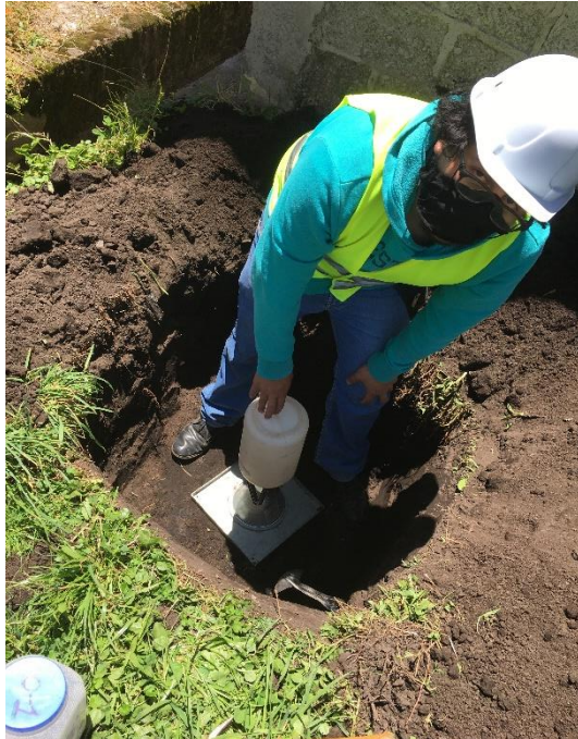
Fig. 19 Densidad de campo (Método del cono y arena de Ottawa).
