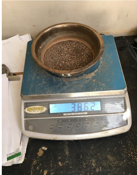
Fig. 23 Contenido de humedad.
