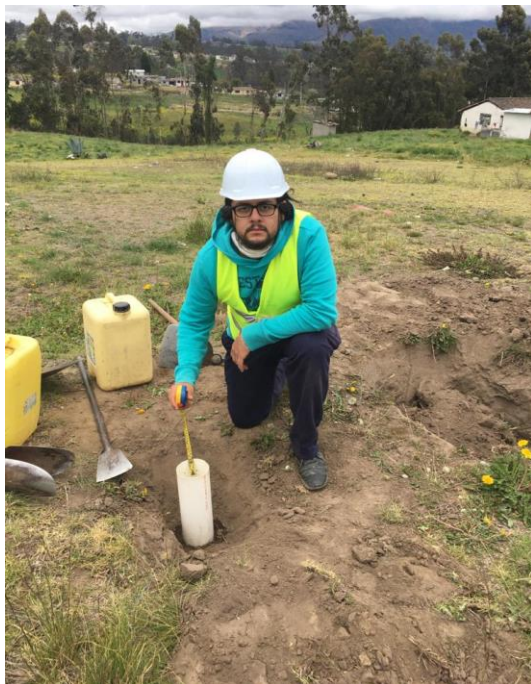
Fig. 20 Permeabilidad (Método de Lefranc: Somera de flujo variable descenso).
