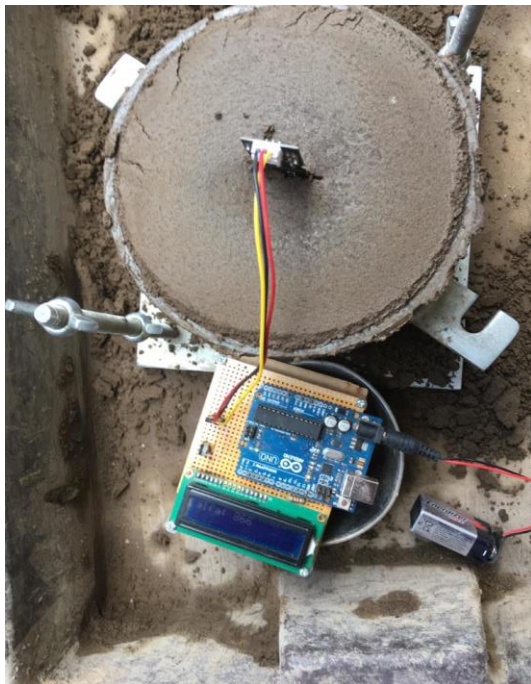
Fig. 30 Contenido de humedad (Muestras de Densidad de Campo – Sensor capacitivo).
