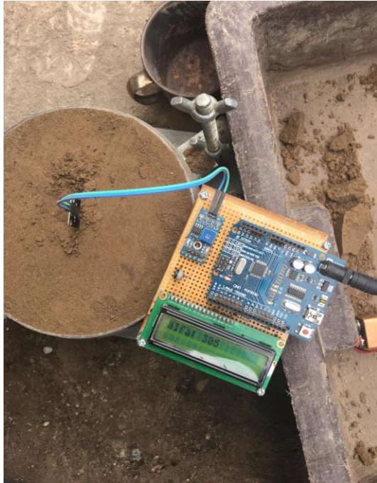
Fig. 31 Contenido de humedad (Proctor modificado Tipo B – Sensor resistivo).
