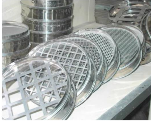
Fig. 6 Algunos tamices utilizados en el proceso de tamizado.
