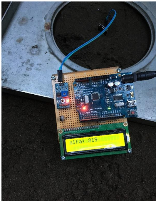
Fig. 26 Contenido de humedad (Muestras de Densidad de Campo – Sensor resistivo).
