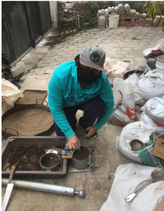
Fig. 28 Contenido de humedad (Proctor modificado Tipo B – Sensor resistivo).
