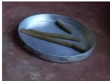
Figura 58: Cordones de suelo para límite plástico
