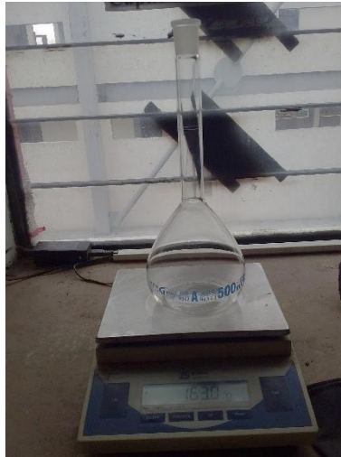
Figura 27: Peso de picnómetro
