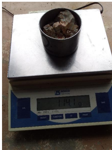
Figura 19: Peso de recipiente + suelo húmedo
