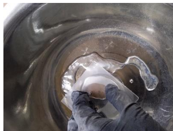
Figura 62: Sumergir pastilla de suelo en mercurio
