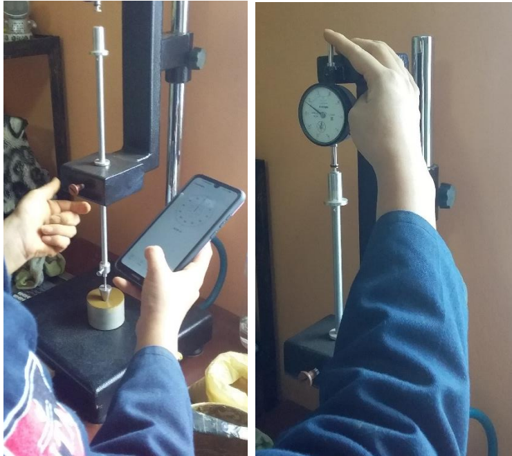
Figura 55: Toma de lectura de penetración
