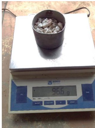
Figura 21: Peso de recipiente + suelo seco
