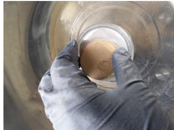
Figura 61: Colocar pastilla de suelo sobre mercurio
