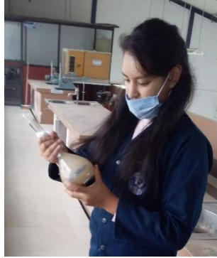
Figura 32: Extraer aire atrapado en picnómetro
