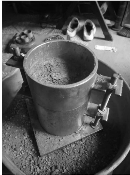
Figura 11: Compactación de la muestra
