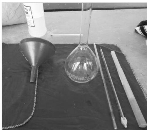
Figura 7: Picnómetro y materiales
