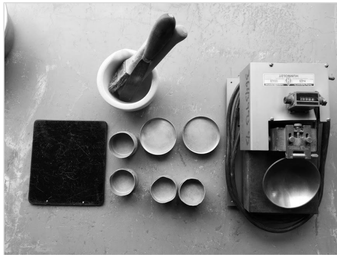
Figura 9: Copa Casagrande y materiales
