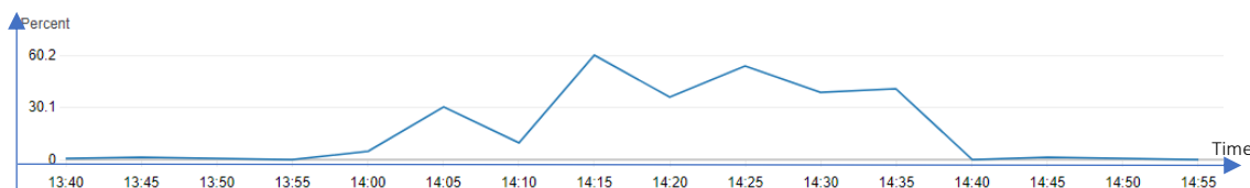
Fig. 113. Porcentaje de uso máximo del CPU del servicio AWS en las pruebas de estrés con 10 usuarios.
