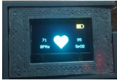
Fig. 99. Pantalla Oled una vez realiza la vinculaci3n bluetooth. Realizado por el investigador.
