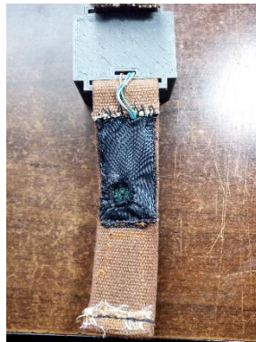
Fig. 77. Protección de tela de color negra para el sensor MAX30100.
