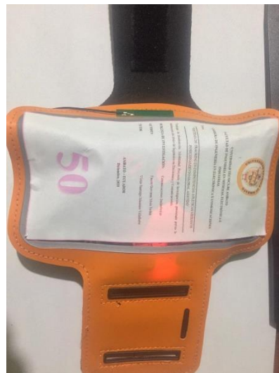
Fig. 38 Verificación de encendido de los leds indicadores.
