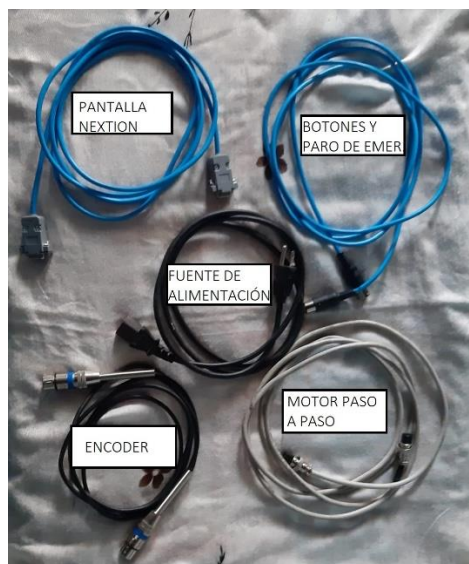
Figura N°- 86 Cables de comunicación del sistema.
