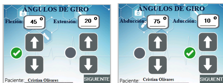
Figura N°- 56 Ángulos de giro en la Pantalla Nextion.
