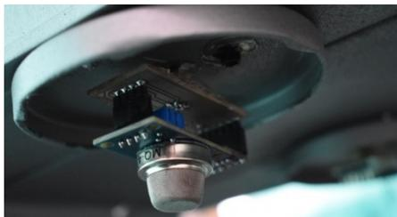
*Figura 49.* Ubicación de los sensores BME280 y MQ-4 sistema anaerobio.
