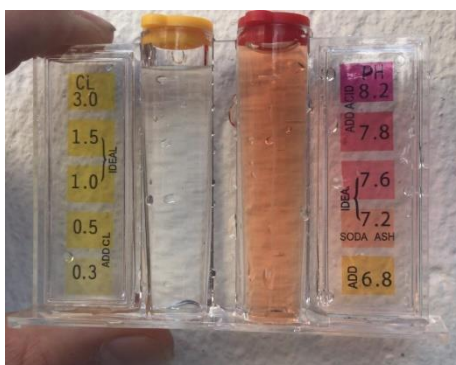
Figura 44. Medición de cloro residual.
