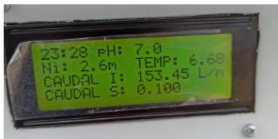
Figura 41. Segunda prueba de lectura de sensores
