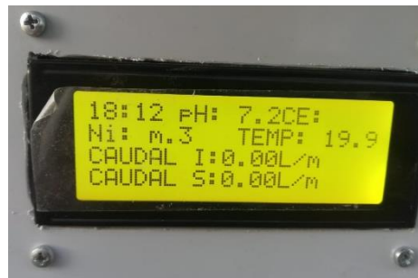
Figura 40. Primera prueba de lectura de sensores
