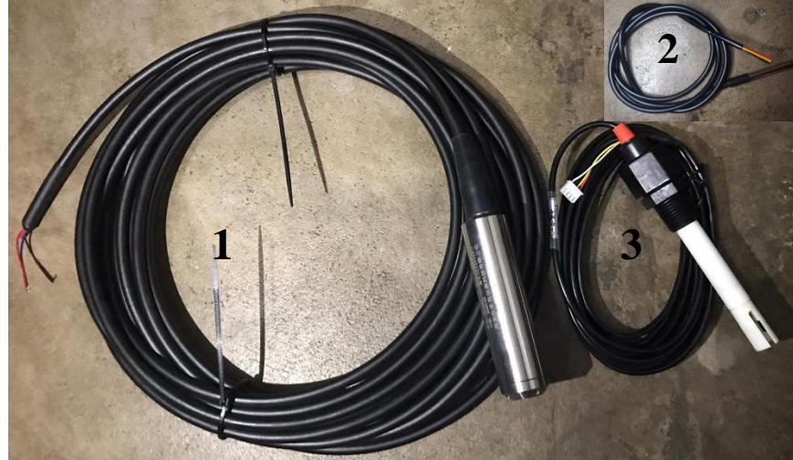
Figura 33. Sensor de nivel (1), sensor de temperatura (2), sensor PH (3).
