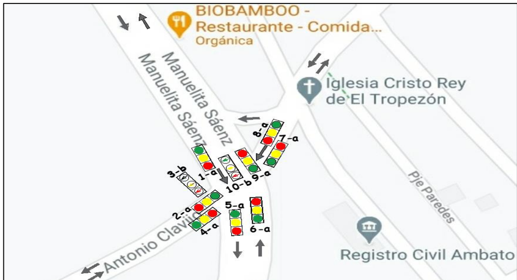
Figura 3-2. SemafORIZACIÓN en la intersección de la av. Manuelita Sáenz y A. Clavijo. Elaborado por: Moyolema, A. (2021).
