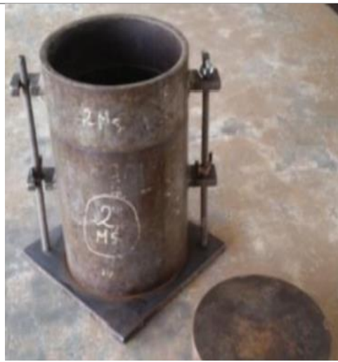
Molde de Compactación
