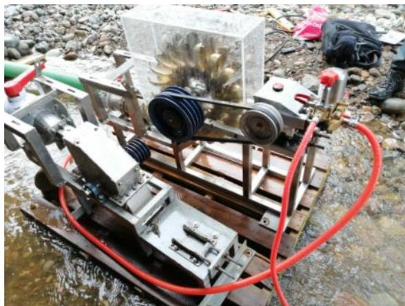
**Figura 50.** Turbina Michel Banki y Pelton.
