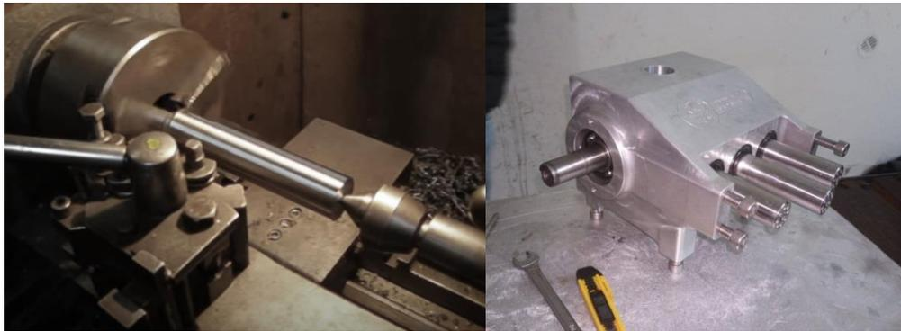
**Figura 45.** Fabricación y ensamblaje pistón.
