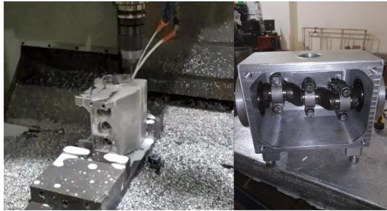
**Figura 44.** Fabricación y ensamblaje de la carcasa.
