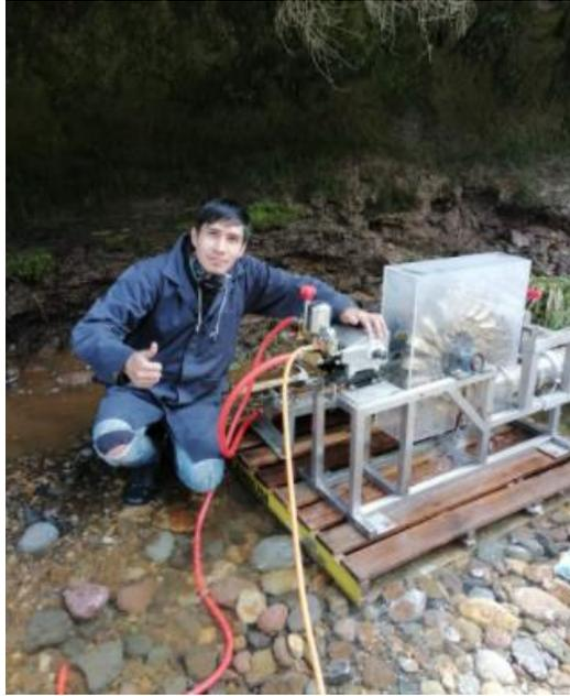
**Figura 53.** Autor de la bomba de pistones adaptada con turbina Michel Banki y Pelton.
