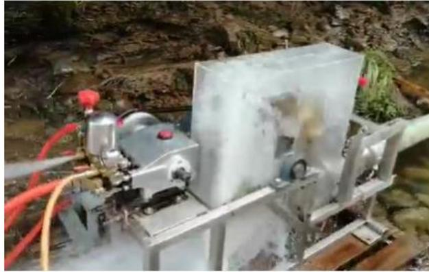
**Figura 51.** Puesta en marcha bomba de pistones con turbina Pelton.
