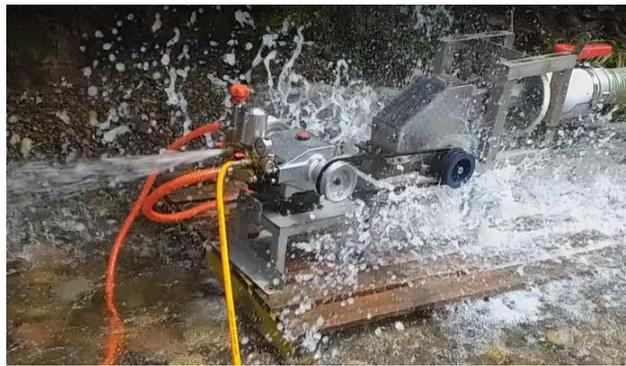
**Figura 52.** Puesta en marcha bomba de pistones con turbina Michel Banki.
