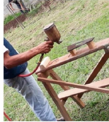
APLICACIÓN DE SELLADOR
