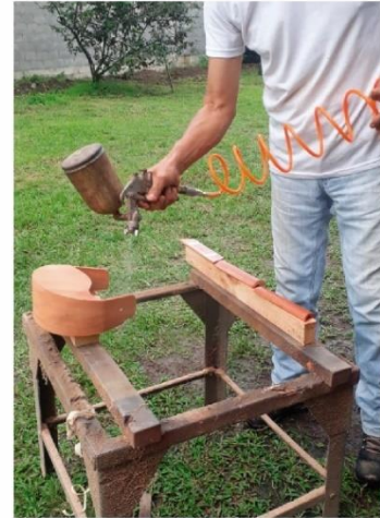
APLICACIÓN DE LACA (ACABADO FINAL)
