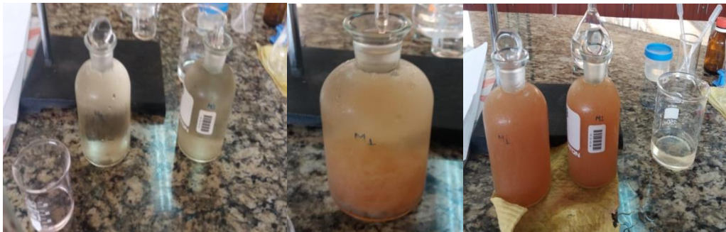
Figura 8. Primera etapa del proceso yodométrico para determinación de Oxígeno Disuelto.
