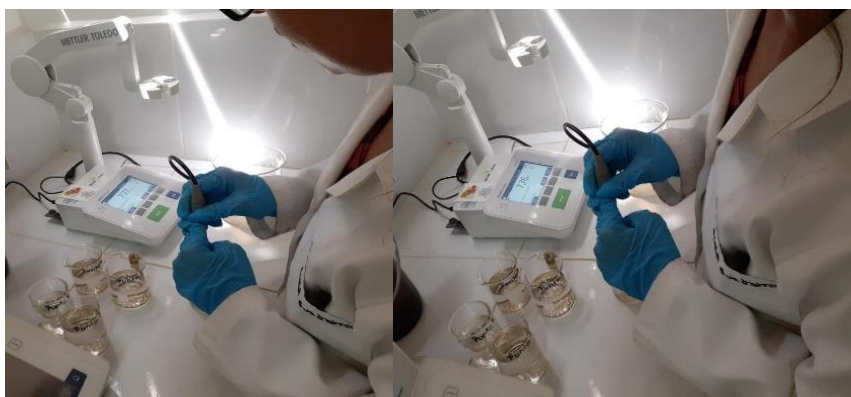
Figura 7. Medición de pH en laboratorio con el potenciómetro Mettler Toledo Seven Compact S220.
