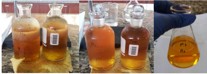
Figura 9. Segunda etapa del proceso yodométrico para determinación de Oxígeno Disuelto.
