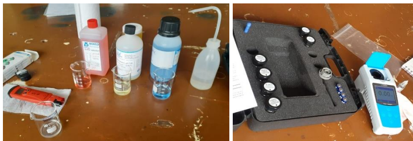
Fotografía 6. Calibración de equipos para pH y turbidez previo al muestreo
