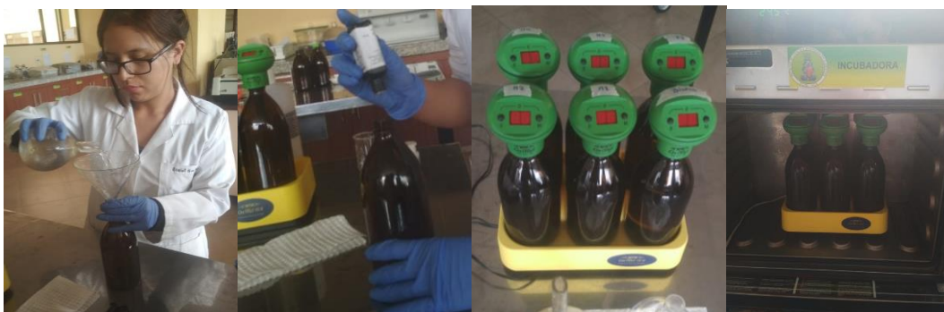
Figura 13. Proceso de DBO 5 mediante equipo Oxitop
