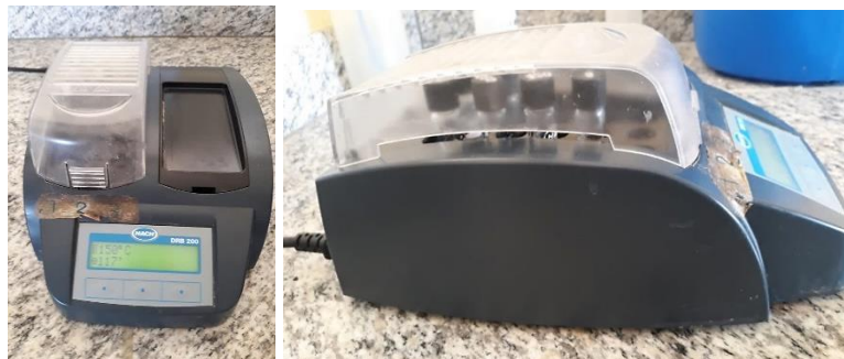
Figura 12. Uso de digestor para determinación de DQO en el Laboratorio 2.2 Química General de la FCIAB.
