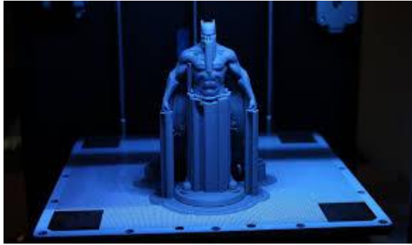
Figura 6. Soportes en impresión 3D FDM [12]
