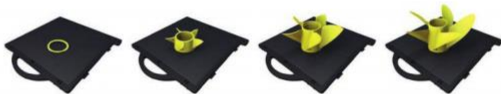
Figura 4. Conformación de una pieza por impresión 3D [8].
