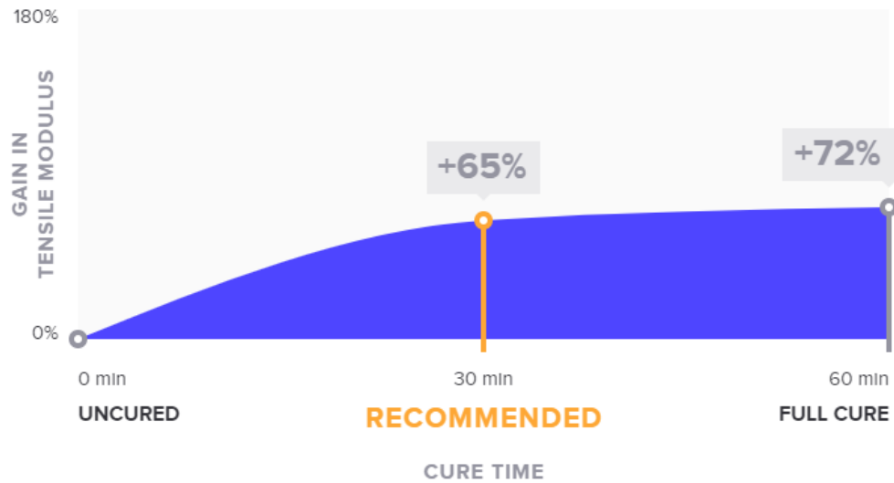
Figura 12. Tiempo y temperatura de post curado para una resina utilizada en estereolitografía [2]
