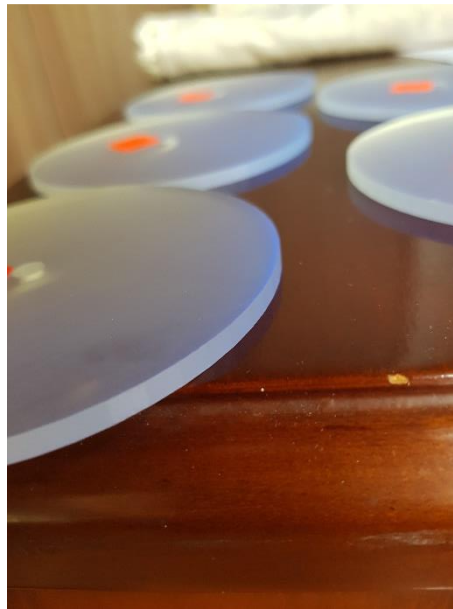
Figura 27. Probetas para ensayo de abrasión de Resina Clear
