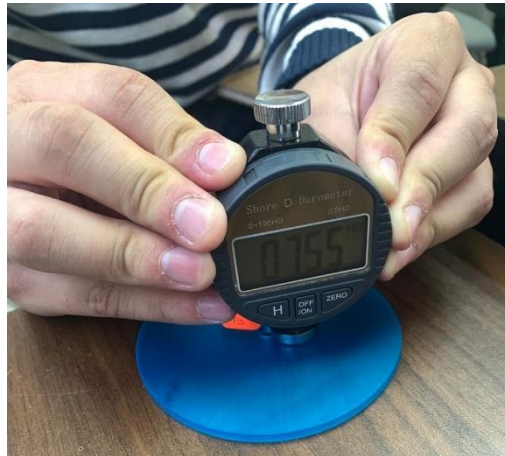
Figura 35. Ensayo de Dureza aplicado a las probetas
