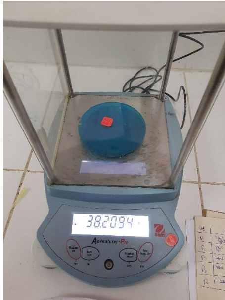
Figura 32. Pesaje de las probetas antes del ensayo de abrasión
