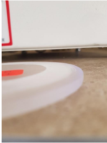
Figura 30. Huella marcada producto del ensayo de abrasión
