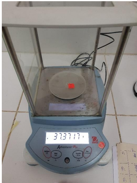
Figura 31. Pesaje de las probetas antes del ensayo de abrasión
