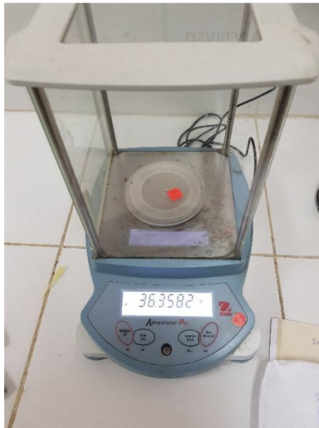
Figura 33. Pesaje de las probetas después del ensayo de abrasión
