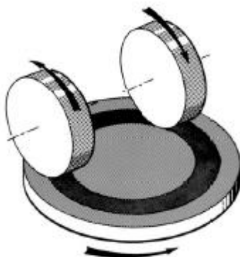
Figura 20. Esquema del sistema giratorio del Abrasímetro. [27]
