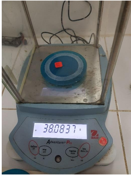
Figura 34. Pesaje de las probetas después del ensayo de abrasión
