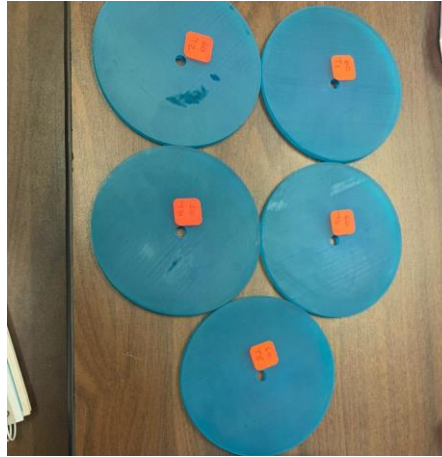
Figura 26. Probetas para ensayo de abrasión de Resina Tough
