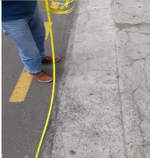
Medición de distancias para estudios de velocidades de punto.
