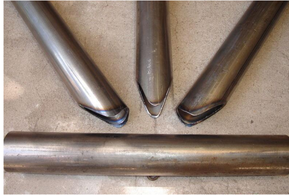
Figura 63: Tipo de corte llamado boca de pescado.
