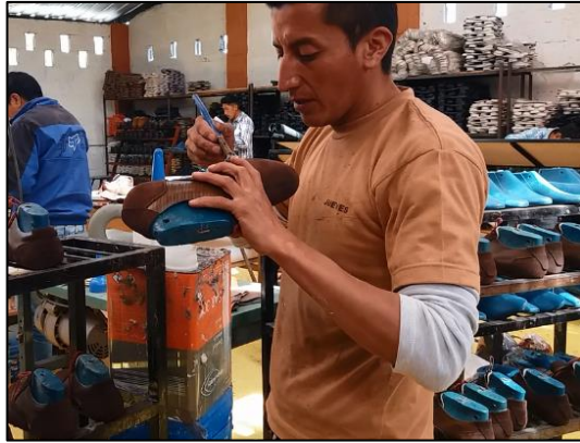
Figura 28. Proceso de pegado
