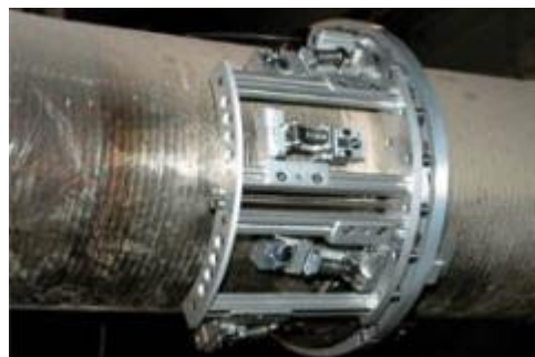
Figura 1. Equipo de ultrasonido semiautomático con aplicación en tuberías. Fuente [2]
