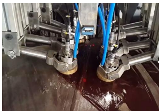
Figura 53. Sistema automático de inspección por ultrasonido. Fuente [22]
