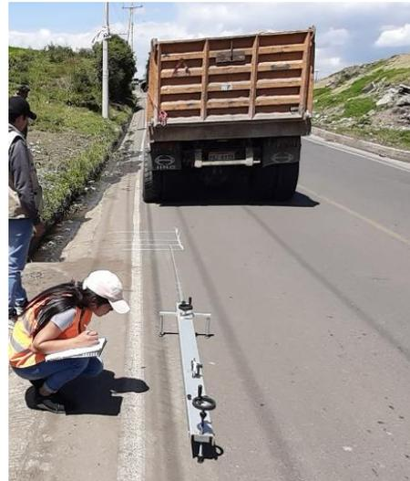
**Descripción:** Anotación de la deflexión marcada del equipo Viga Benkelman.
