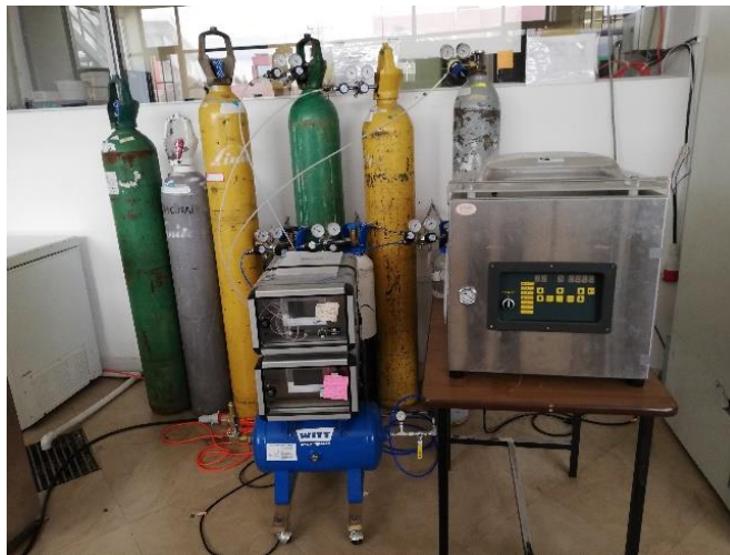
Imagen 1. Equipo de atmósferas modificadas.
