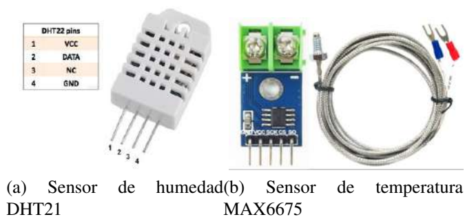
Figura 3.2: Sensor de temperatura y humedad [49].
