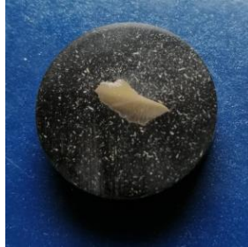
Figura 21. Ataque químico de probetas con Nital 2.
