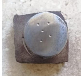
Figura 17. Obtencion de huella del identador en probetas.
