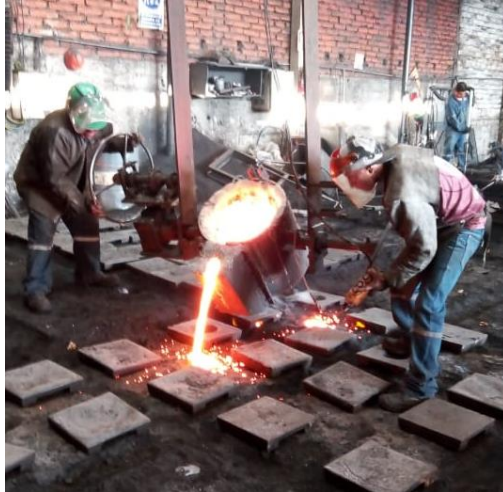
Figura 8. Bloque de quilla para probetas de ensayos (longitud= 152mm)
