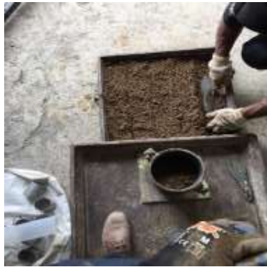
Foto N°27. Ensayo de Proctor
