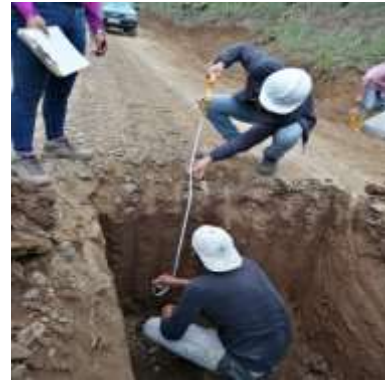
Foto N°14. Extracción de Muestras de Suelo
