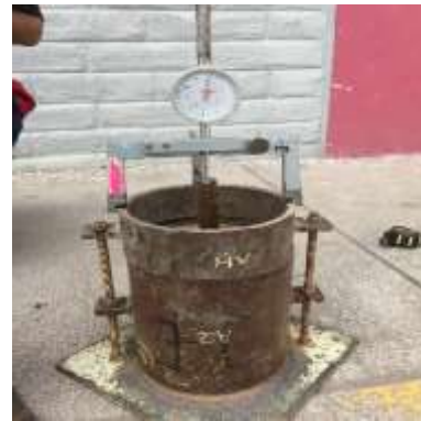
Foto N°36. Medición de Esponjamiento Antes de Sumergir la Muestra
