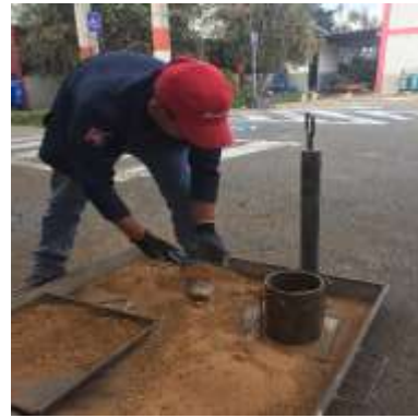
Foto N°28. Ensayo de Proctor
