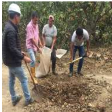
Foto N°11. Extracción de Muestras de Suelo
