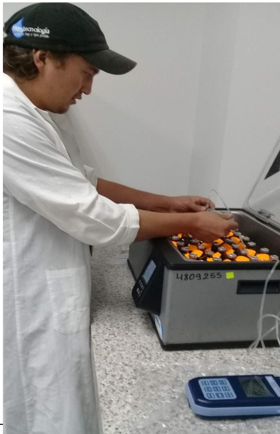
Sellado hermético de los frascos y colocación en baño maría a 39°C
