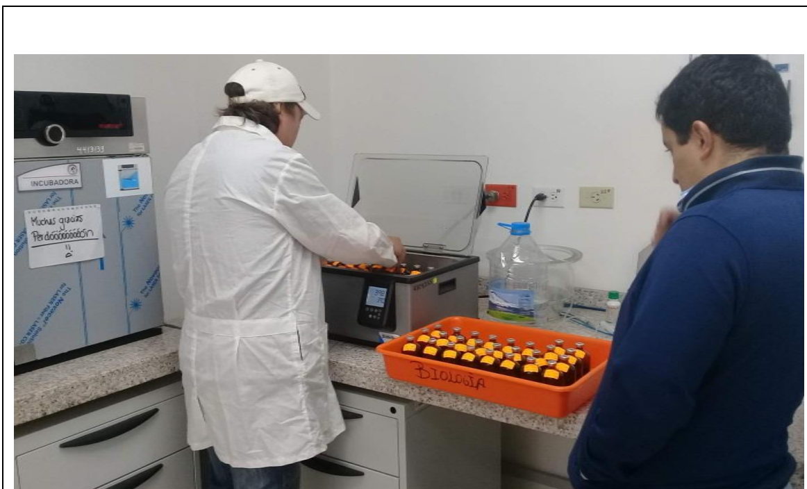
Toma de datos de volumen de gas con transductor de presión DELTA OHM-PRESSURE METER HD2124.2
