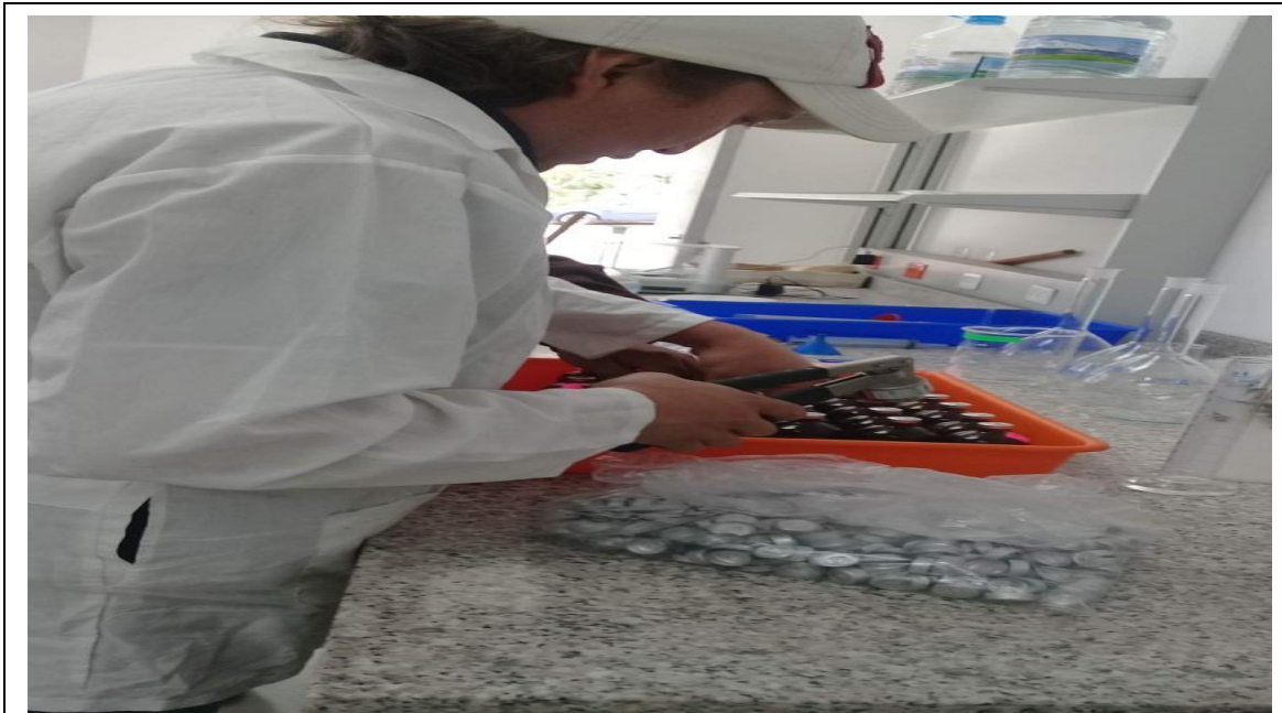
Sellado hermético de los frascos y colocación en baño maría a 39°C
