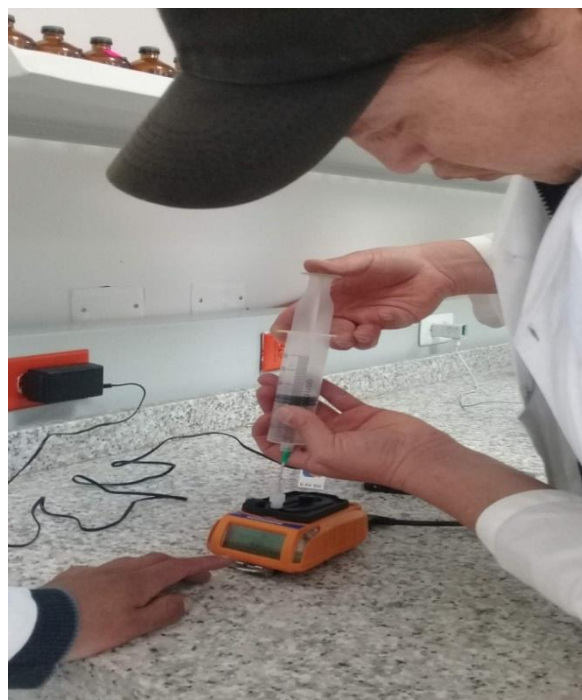
Toma de datos de volumen de gas con transductor de presión DELTA OHM-PRESSURE METER HD2124.2
