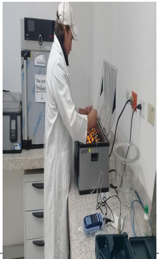
Sellado hermético de los frascos y colocación en baño maría a 39°C
