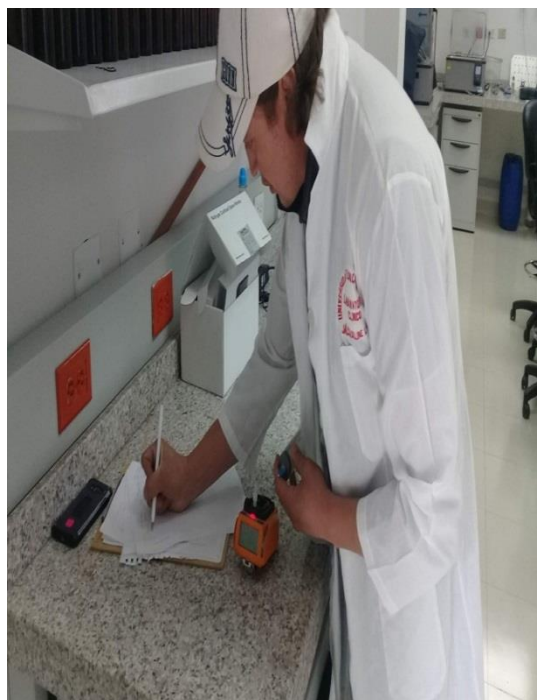
Toma de datos de volumen de gas con transductor de presión DELTA OHM-PRESSURE METER HD2124.2
