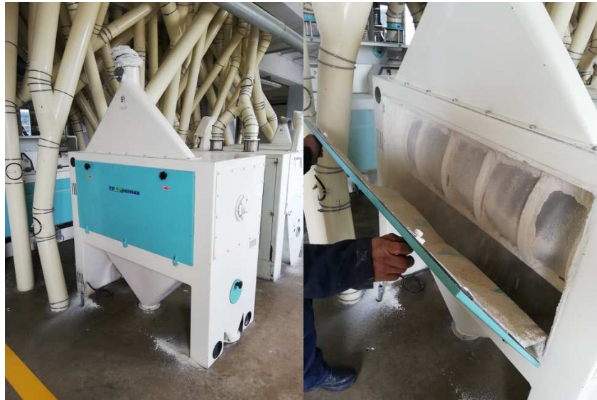
Figura 46.- Identificación de los focos de suciedad en la terminadora de afrecho Bf1 Fuente: Autor
