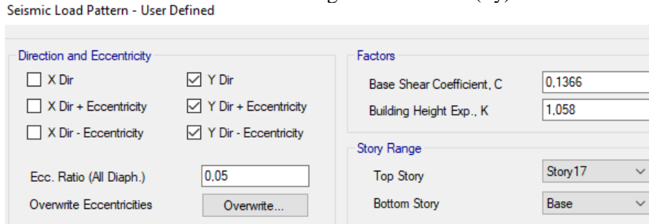
Ilustración 36.- Carga sísmica en Y (Sy).
