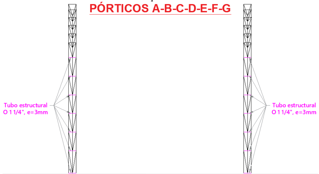
Ilustración 27.- Elementos corta pandeo: vista lateral derecha y vista lateral izquierda.
